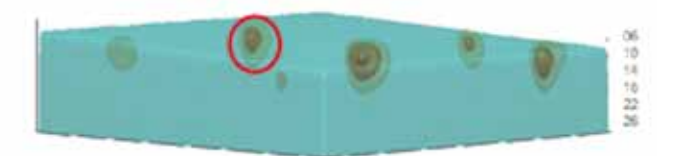
Vue tomographique de l'écho visualisant un faible enfouissement < 1m
